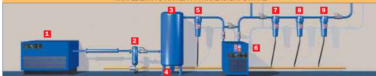
1. Αεροσυμπιεστής 2. Φυγοκεντρικός διαχωριστής 3. Αεροφυλάκιο 4. Αυτόματη αφυδάτωση 5. Φίλτρο QF 6. Ξηραντής 7. Φίλτρο PF 8. Φίλτρο HF 9. Φίλτρο CF
