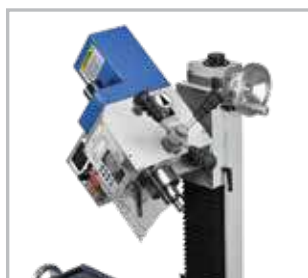
Κλίση κεφαλής δεξιά-αριστερά ± 90°
