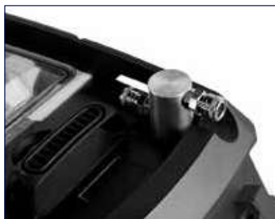
Υποδοχή για σύνδεση με εργαλεία αέρος
